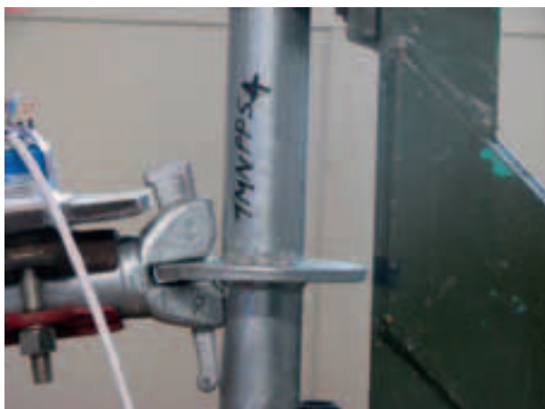
Figura 4.2.1.7-8: Deformazione del sistema oltre il contatto cuneo-montante
