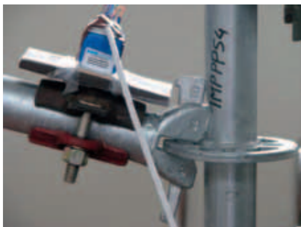
Figura 4.2.2.6-2: Deformazione al 47° minuto di prova
