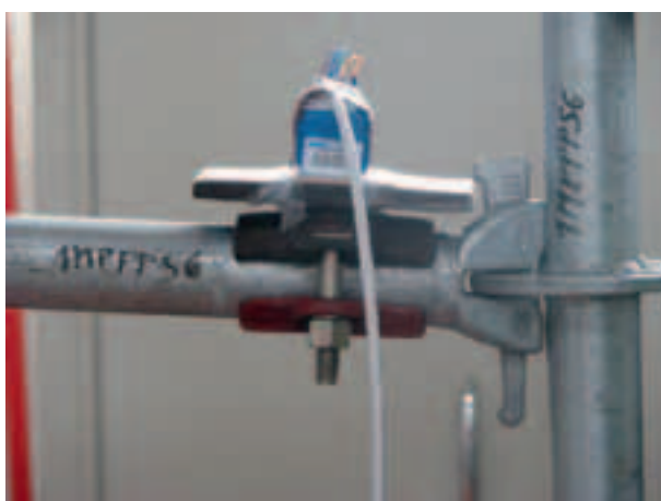
Figura 4.2.2.8-5: Deformazione al 9° minuto di prova
