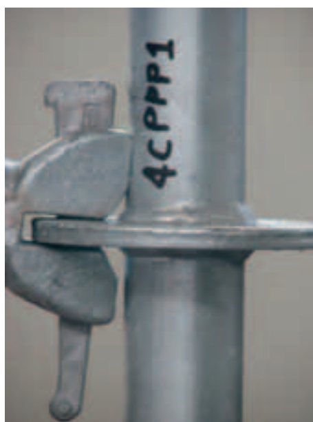
Figura 4.2.8-13: Deformazione al 226° minuto di prova
