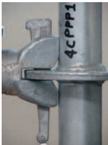
Figura 4.2.8-8: Deformazione al 138° minuto di prova
