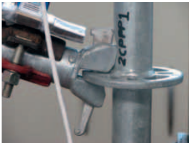
Figura 4.2.4-7: Deformazione al 89° minuto di prova
