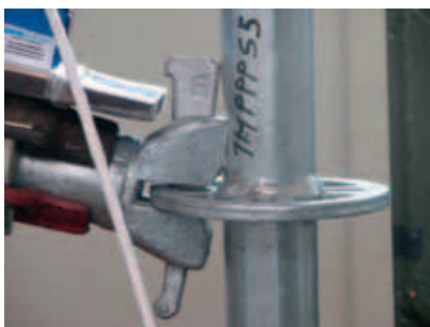
Figura 4.2.2.7-7: Deformazione al 38° minuto di prova (evento c)
