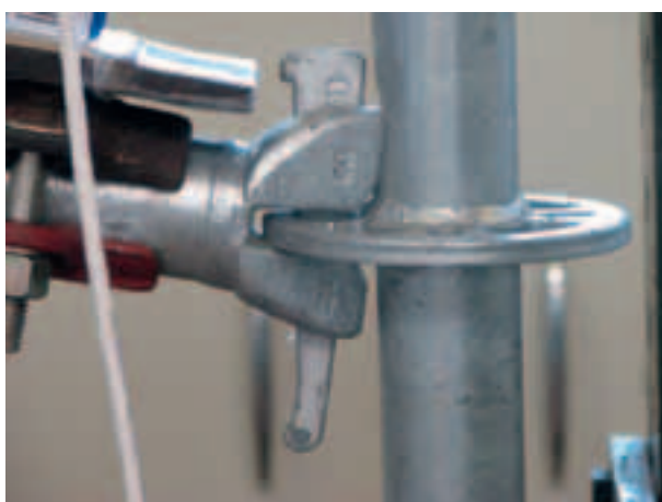
Figura 4.2.6-17: Deformazione al 280° minuto di prova
