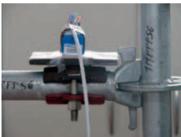
Figura 4.2.2.8-4: Deformazione al 1° minuto di prova (evento a)
