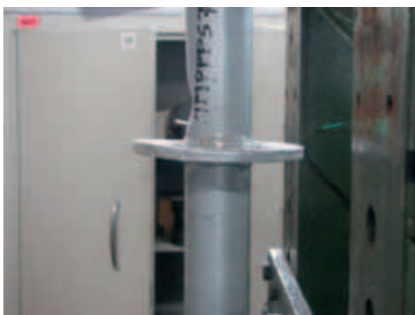
Figura 4.2.2.9-13: Fine prova - Deformazione permanente del montante al contatto con la forchetta e della rosetta – vista laterale
