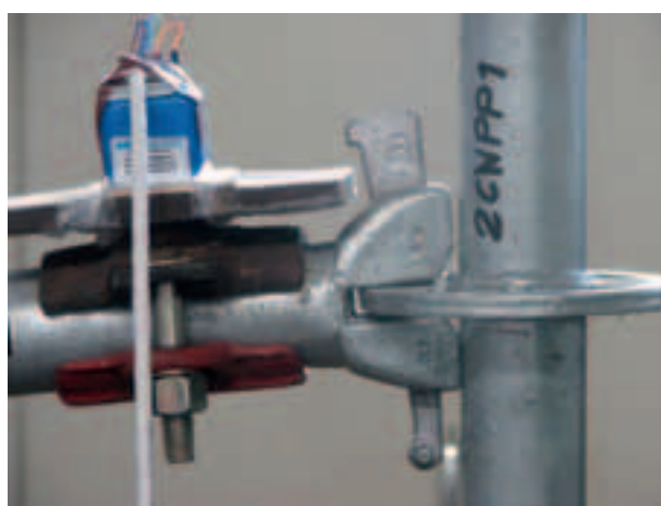
Figura 4.2.3-6: Deformazione al 39° minuto di prova
