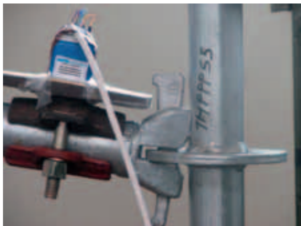
Figura 4.2.2.7-6: Deformazione al 30° minuto di prova
