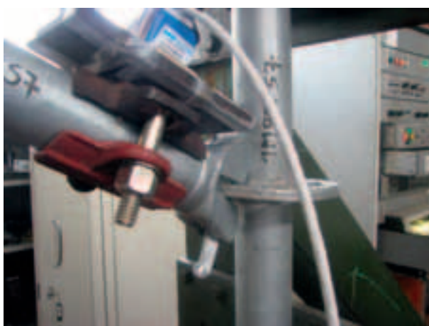
Figura 4.2.2.9-8: Deformazione al 81° minuto di prova
