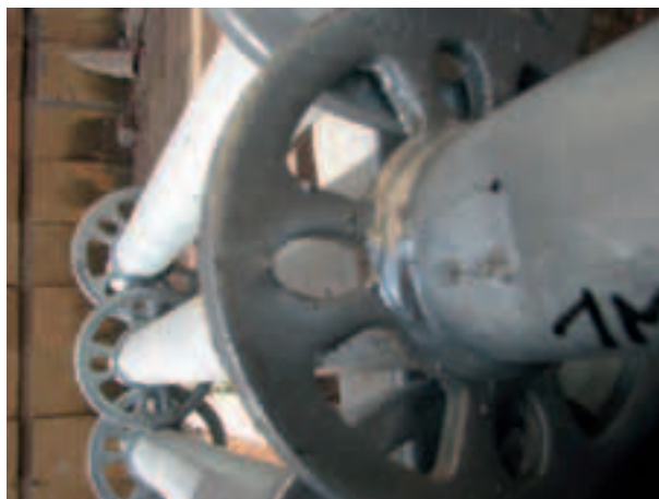
Figura 4.2.2.1-4: Fine prova Deformazione permanente del montante al contatto con la forchetta – dettaglio 2
