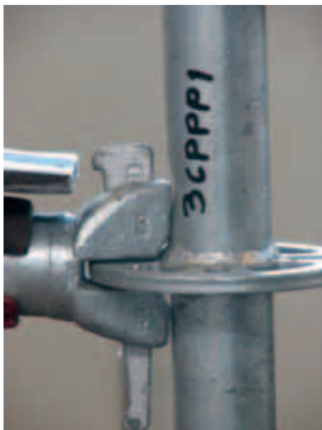
Figura 4.2.6-21: Deformazione al 299° minuto di prova
