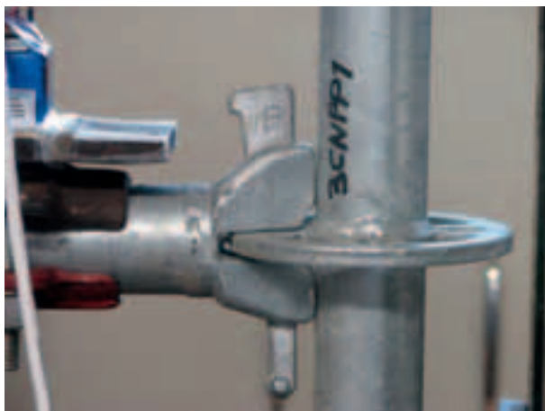
Figura 4.2.5-6: Deformazione al 105° minuto di prova
