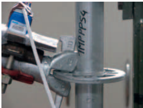
Figura 4.2.2.6-3: Deformazione al 57° minuto di prova
