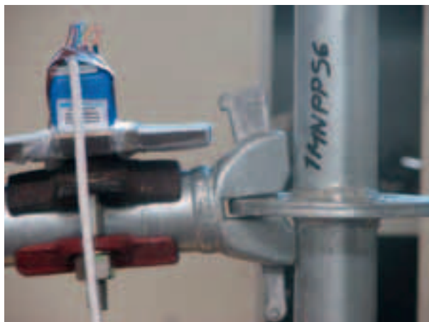
Figura 4.2.1.9-6: Deformazione al 18° minuto (primo massimo locale M L )
