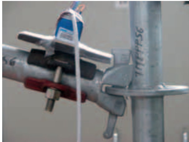
Figura 4.2.2.8-9: Deformazione al 47° minuto di prova
