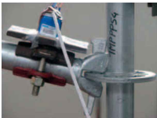
Figura 4.2.2.6-10: Deformazione al 44° minuto di prova
