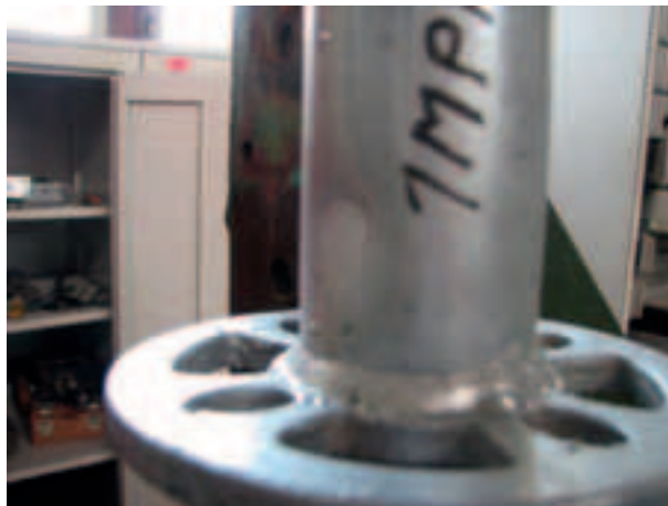
Figura 4.2.2.4-10: Fine prova - Deformazione permanente del montante al contatto con la forchetta
