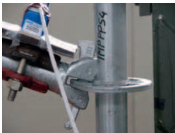
Figura 4.2.2.6-5: Deformazione al 63° minuto di prova
