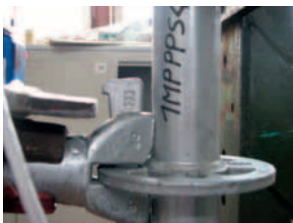
Figura 4.2.2.6-7: Deformazione al 19° minuto di prova
