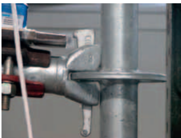
Figura 4.2.6-8: Deformazione al 124° minuto di prova
