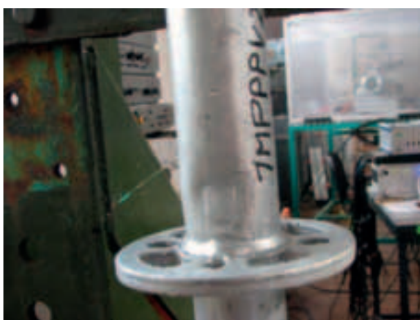
Figura 4.2.2.2-7: Fine prova - Deformazione permanente del montante al contatto con la forchetta
