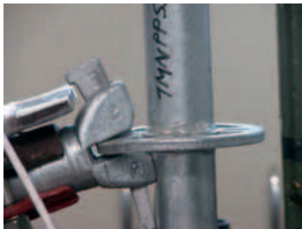
Figura 4.2.1.7-13: Deformazione del sistema oltre il contatto cuneo-montante
