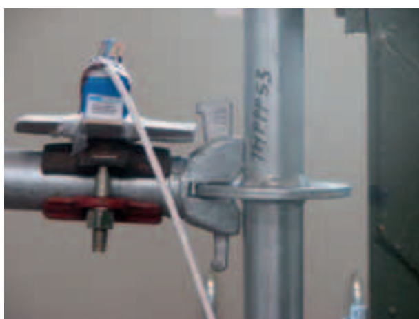
Figura 4.2.2.7-4: Deformazione al 10° minuto di prova
