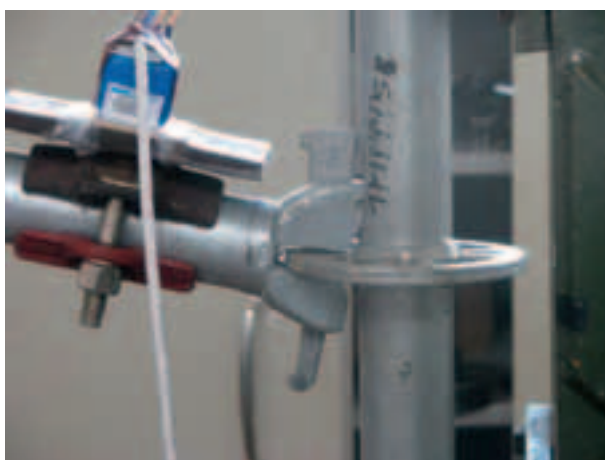
Figura 4.2.2.10-4: Deformazione al 18° minuto di prova
