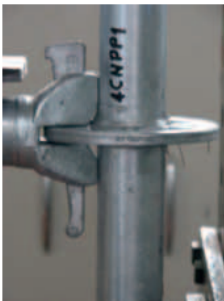
Figura 4.2.7-7: Deformazione al 143° minuto di prova
