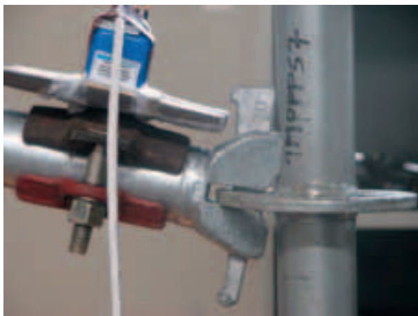
Figura 4.2.2.9-6: Deformazione al 39° minuto di prova
