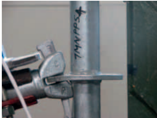
Figura 4.2.1.7-12: Deformazione del sistema oltre il contatto cuneo-montante
