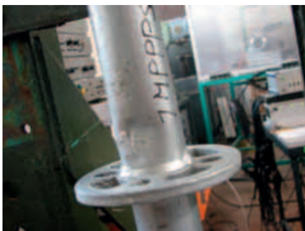
Figura 4.2.2.3-7: Fine prova - Deformazione permanente del montante al contatto con la forchetta dettaglio 2
