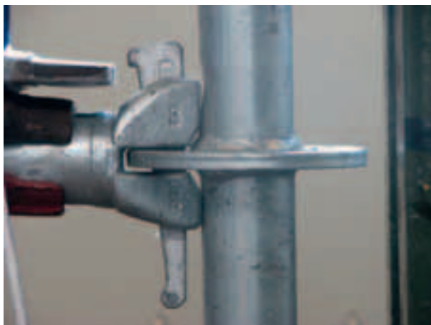
Figura 4.2.6-15: Deformazione al 250° minuto di prova
