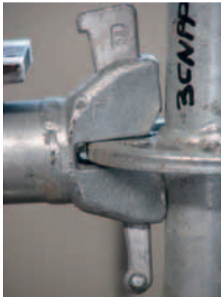
Figura 4.2.5-9: Deformazione al 141° minuto di prova
