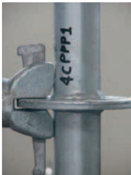
Figura 4.2.8-16: Deformazione al 242° minuto di prova
