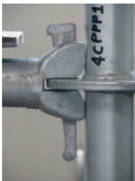
Figura 4.2.8-15: Deformazione al 242° minuto di prova
