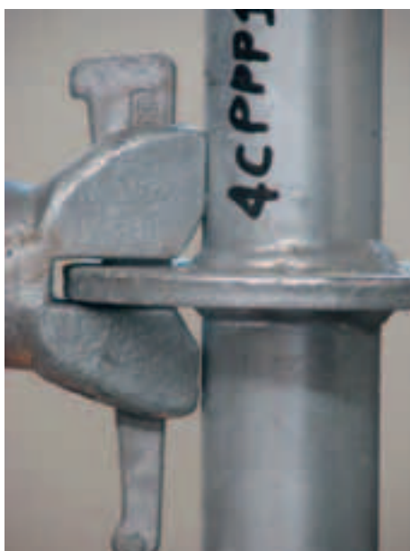
Figura 4.2.8-7: Deformazione al 138° minuto di prova
