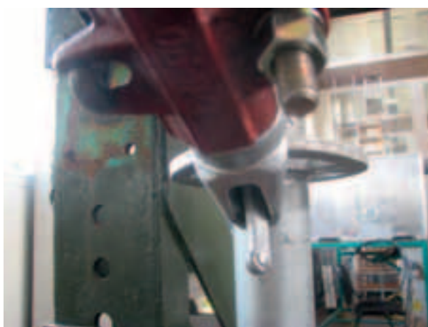
Figura 4.2.2.9-7: Deformazione al 81° minuto di prova
