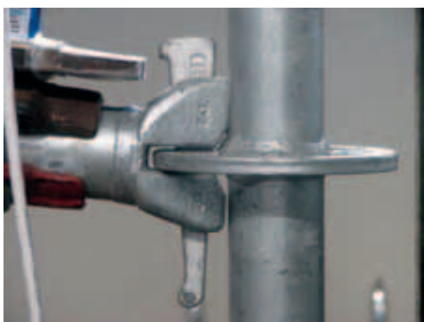
Figura 4.2.6-10: Deformazione al 128° minuto di prova
