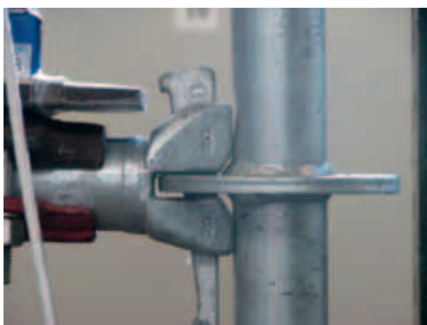
Figura 4.2.6-16: Deformazione al 253° minuto di prova
