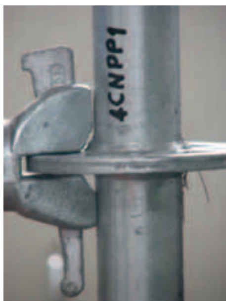
Figura 4.2.7-5: Deformazione al 65° minuto di prova
