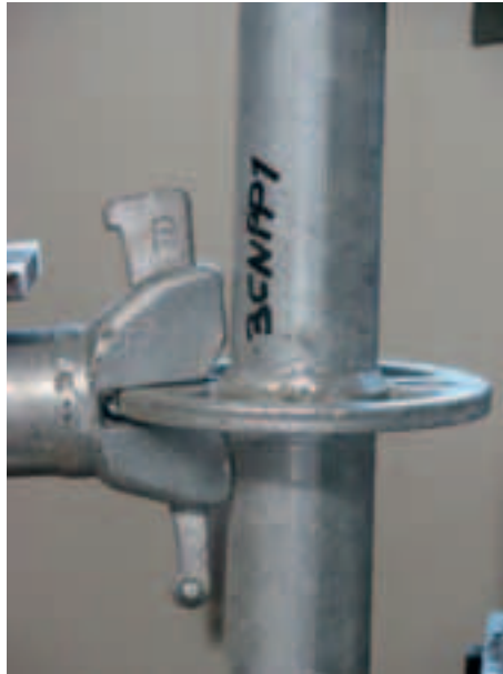
Figura 4.2.5-8: Deformazione al 141° minuto di prova
