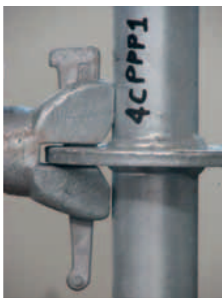
Figura 4.2.8-9: Deformazione al 173° minuto di prova
