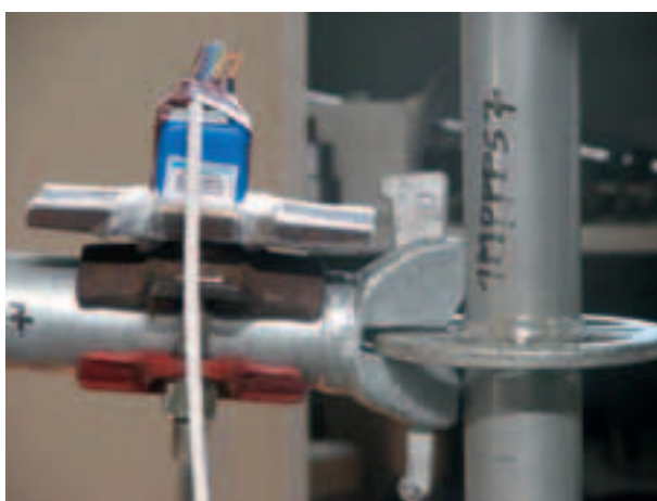
Figura 4.2.2.9-4: Deformazione al 15° minuto di prova
