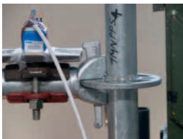
Figura 4.2.1.7-4: Deformazione al 6° minuto di prova
