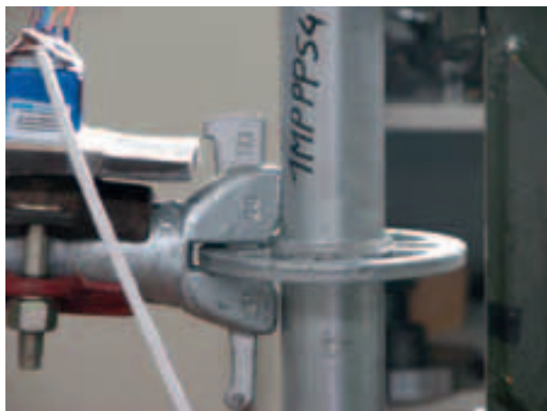
Figura 4.2.2.6-6: Deformazione al 14° minuto di prova
