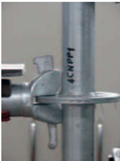
Figura 4.2.7-6: Deformazione al 103° minuto di prova
