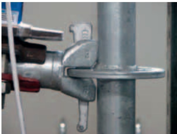
Figura 4.2.6-9: Deformazione al 126° minuto di prova
