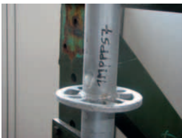
Figura 4.2.2.9-12: Fine prova - Deformazione permanente del montante al contatto con la forchetta
