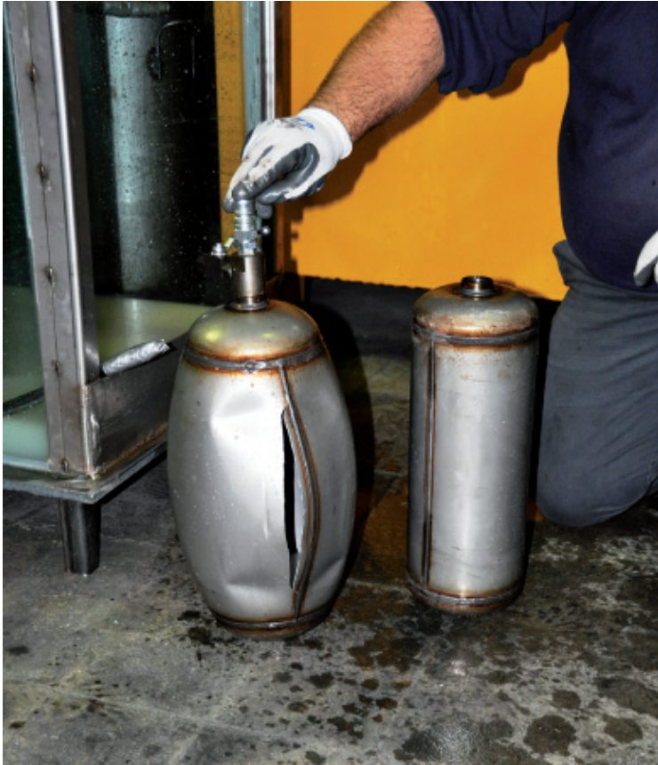
Ciclo di produzione di un serbatoio per estintori: prove collaudo e scoppio
