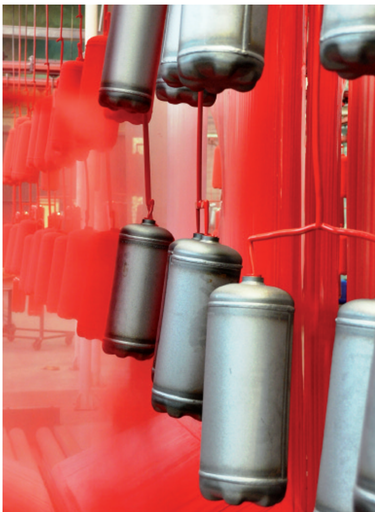
Ciclo di produzione di un serbatoio per estintori: verniciatura
