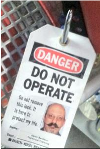
Figura 1: Esempio di applicazione di cartellino di avvertimento personalizzato in congiunzione al lucchetto
