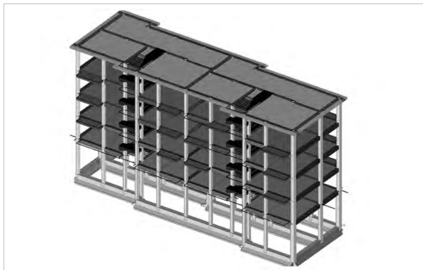
Figura 7.2 - Immagine 3D del modello strutturale dell'edificio esistente
