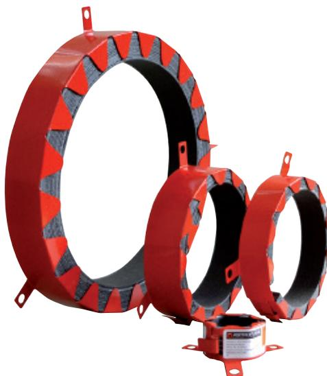
tutti testati secondo le EN 1366-3, classe E in accordo alla EN13051-1, resistenza al fuoco ed installazione secondo EN 13501-2 si veda ETA15/0617 - 0618 - 0619, adatti per uso su tubazioni in UPVC, ABS, MDPE, GDPE, e PP, resistenza al fuoco fino a EI-E 180. Ziggiotto è in grado di offrire un prezioso supporto tecnico specializzato, veloce e
