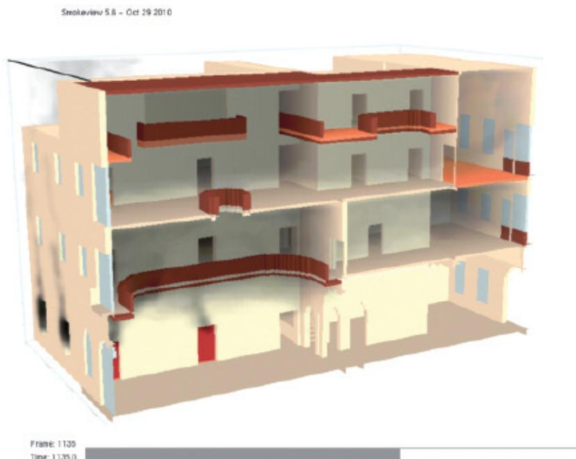
Figura 4 - La particolare conformazione della “sala rovescia” favorisce l’effetto camino
