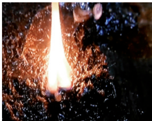
Test di accensione sul grasso lubrificante sporco
