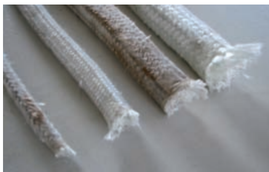
Le caratteristiche chimiche e fisiche delle MMVFs rendono i manufatti contenenti tali fibre ottimi isolanti termici ed acustici. Foto in alto pannelli; in basso cordini.
