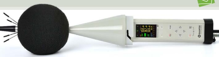
può registrare il segnale audio nei file WAVE per il riconoscimento delle fonti di rumore e la post elaborazione con software.
