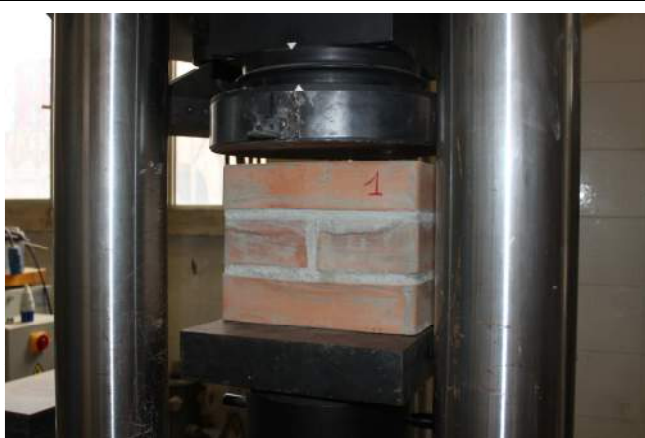
15/06/2015– figura 62 Provino n. 1 tra i piatti della pressa
