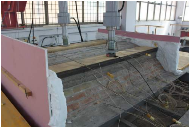
06/07/2015– figura 74 Esecuzione della prova (applicazione e controllo del carico)
