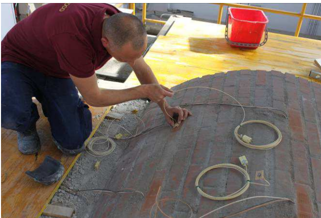
19/5/2015 – figura 38 Applicazione delle termocoppie sulla faccia non esposta con colla ceramica
