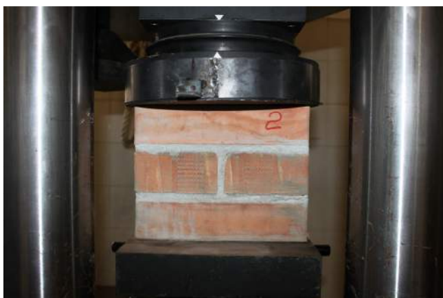
15/06/2015– figura 64 Provino n. 2 tra i piatti della pressa
