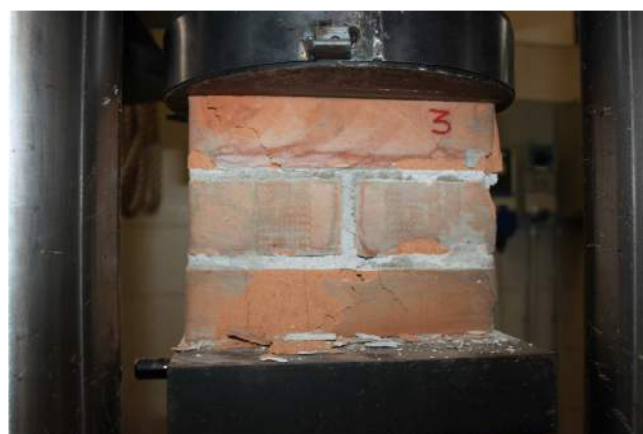
15/06/2015– figura 67 Provino n. 3 in condizioni di rottura ( \sigma_{\max} = 12,4\text{N/mm}^2 )
