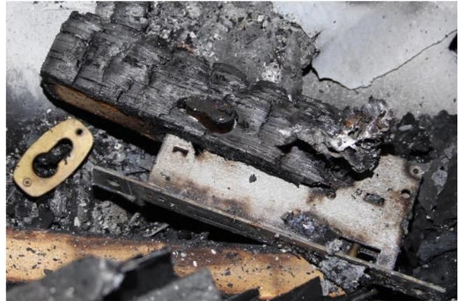
A sinistra vediamo una plafoniera in plastica parzialmente fusa, il che può fornire un'utile indicazione sulle temperature che si sono sviluppate a causa dell'incendio. A destra vediamo un altro particolare importante: la serratura, ritrovata in terra dopo l'incendio, non aveva la mandata inserita. Entrambe le foto sono state scattate in modalità tele.
