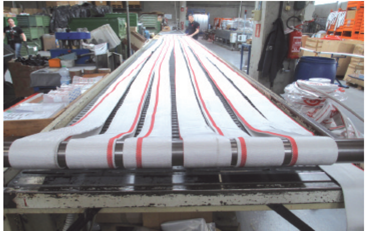
Reparto di produzione di manichette antincendio
