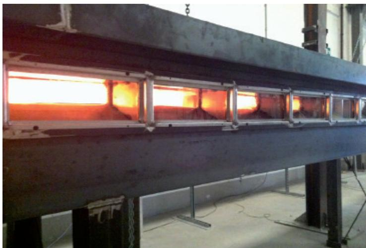
guire la prova ASTM E 84 (USA) “Caratteristiche di combustione dei materiali costruttivi” generalmente chiamato Steiner (Tunnel) Test per la determinazione della propagazione delle fiamme e la produzione di fumo dei rivestimenti in superficie.
