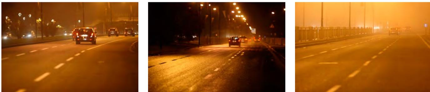
Figura 2 - A sinistra, una strada asciutta. Al centro, la stessa strada bagnata: osservare le riflessioni di Brewster nelle zone di allineamento fra apparecchio di illuminazione, strada e occhio del conducente. A destra, la stessa strada con nebbia: la diffusione interessa l'intero campo visivo
