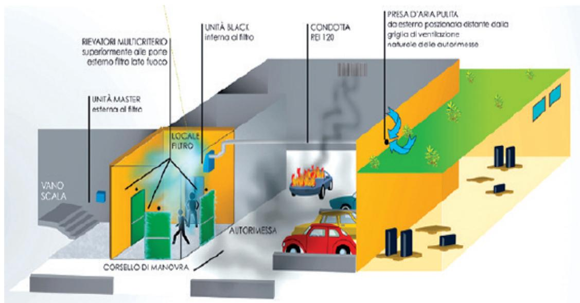
Master Black - Sistema di pressurizzazione filtri a prova di fumo conforme al D.M. 30.11.1983 ed alle norme UNI EN 12101-6:2005
