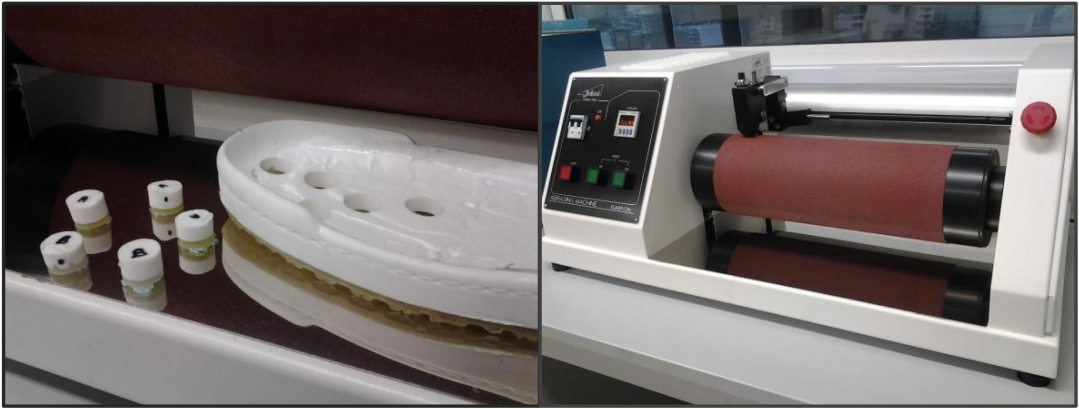
Figura 4 - Campioni e configurazione di prova per i test di resistenza all'abrasione
