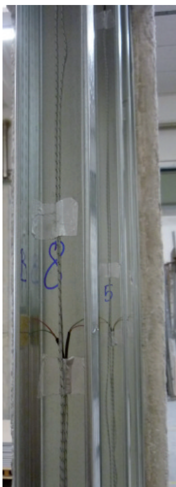
Foto 3 - Posizionamento termocoppie sui montanti
