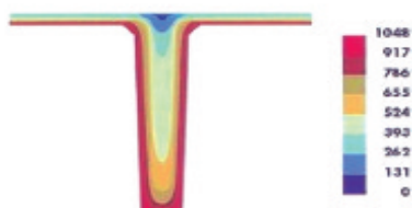
Esempio di mappatura termica a banda di calore (T = 120')
