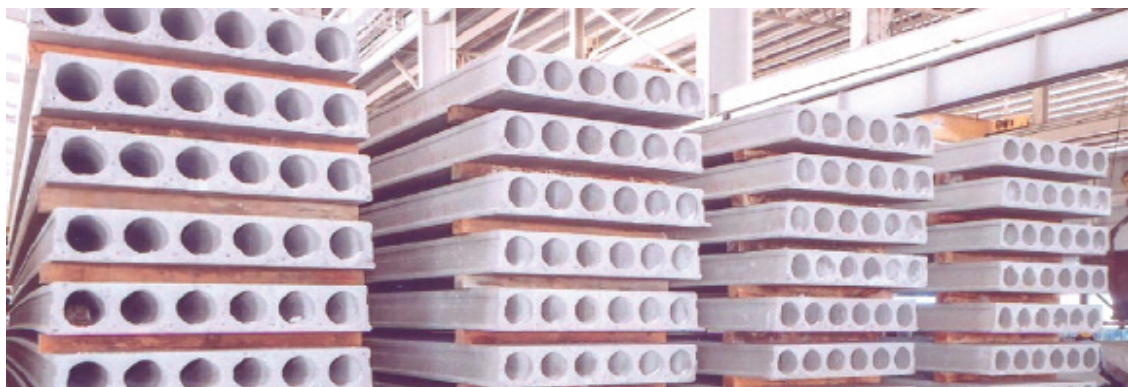
Figura 5 - Stoccaggio in magazzino di lastre alveolari
