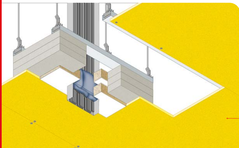
Global Cross: attraversamento di blindosbarre di grandi dimensioni a controsoffitto
