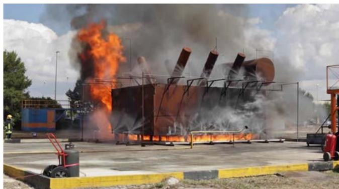
Test in scala reale condotto presso la sede di Tema Sistemi SpA per la protezione di trasformatori
