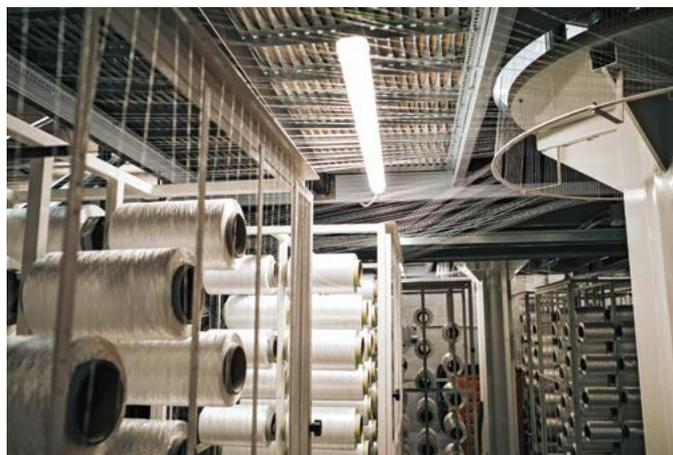
Telai circolari all'interno dello stabilimento, utilizzati per la realizzazione della calza tessile delle manichette antincendio
