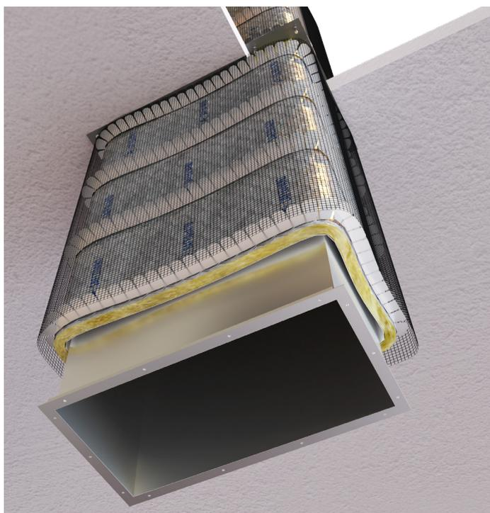
AF Safeguard ridefinisce la protezione degli attraversamenti di condotte metalliche minimizzando gli spessori dell'isolamento grazie all'uso congiunto di uno **strato di rivestimento ablativo** che raffredda la condotta e di una **intercapedine d'aria** che favorisce il raffreddamento per convezione tra materassino e rete di sicurezza esterna.
