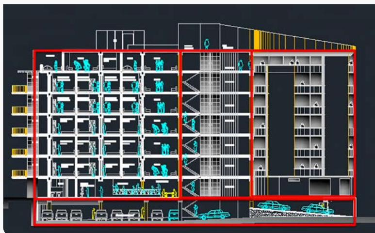
La compartimentazione di un edificio (in questo caso un hotel) in differenti sezioni "stagne"
