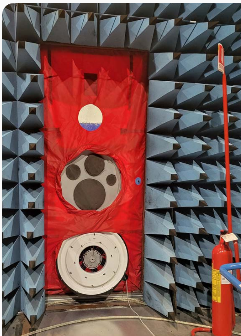
Figura 5 | Macchina del Door Fan Test della BlowerDoor usata per la prova di tenuta
