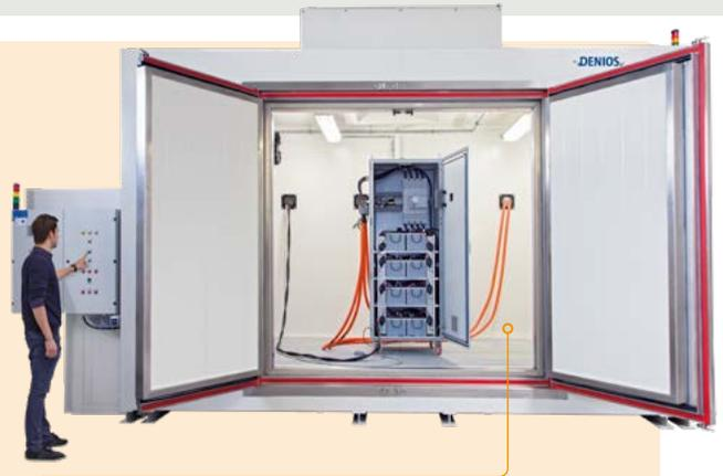
**SOPRA** > "Locale di prova": Locale di prova per accumulatori stazionari di energia.
