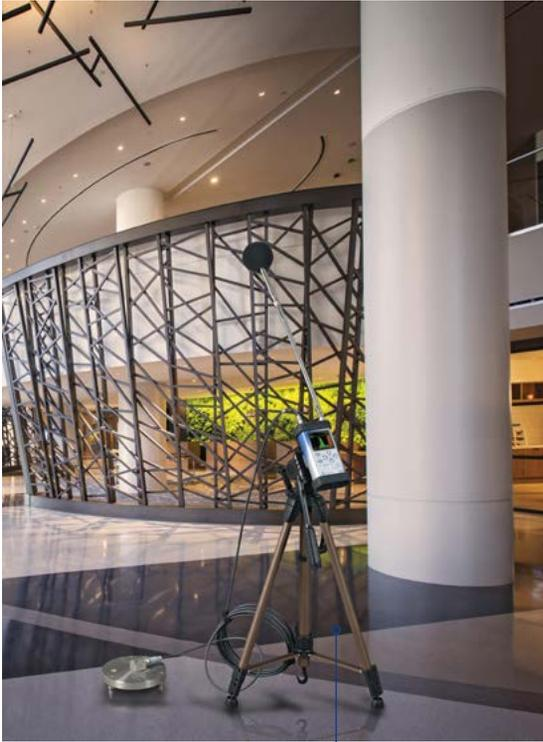
SVAN 958A con accelerometro per edifici (canali da 1 a 3) e kit per misure di rumore (canale 4).
