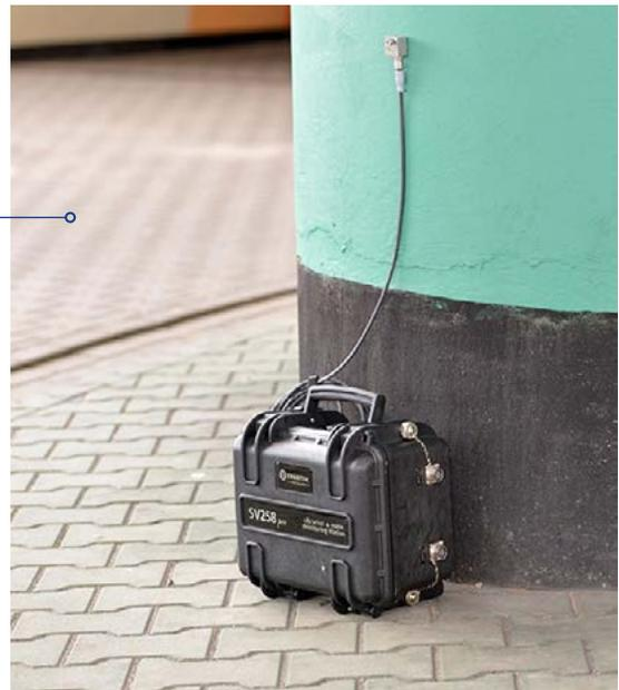
L'operatività della batteria interna può essere facilmente estesa connettendo il sistema ad una batteria esterna o ad un pannello solare. Il controller (sistema intelligente) gestisce la ricarica della batteria interna: per esempio abilita l'utilizzo del pannello solare senza avvalersi di alcun altro accessorio.
