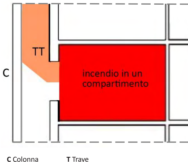
Figura 4-11 – Criteri di progetto in condizioni di incendio per elementi strutturali posti all'esterno
