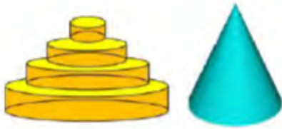
Figura 4-3 - Modellazione di un incendio localizzato secondo un diverso grado di approssimazione
