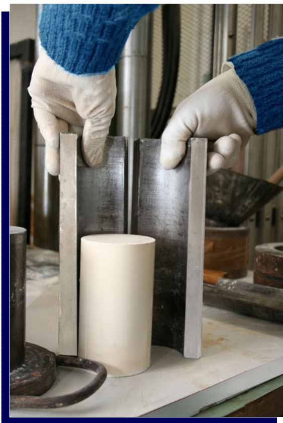
Fasi del processo di produzione del compound: estrazione
